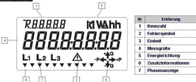
Die **Anlauferkennung** stellt den aktuellen Energiebezug dar, wie er vom Zähler gemessen wird. Über die entsprechenden Pfeile erfolgt die Richtungsanzeige für Wirk- und Blindleistung.
