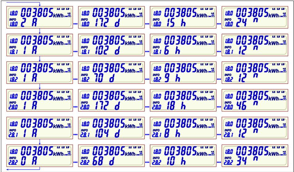
Anzeige der Betriebszeiten für die einzelnen Energie-Register. Es werden nur die Register angezeigt die im Zähler verfügbar sind. Die Anzeige der Einheiten rolliert alle ca. 2 Sek. Durch einen kurzen Tastendruck springt man in das nächste Register.
