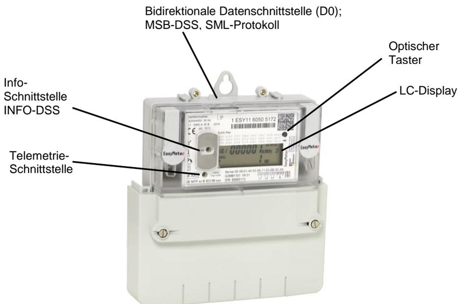
Die Zählergehäuse sind verschweißt und als „Sealed-forever“ Geräte ausgeführt. Hinweis: Die mechanischen Schnittstellen, die Spannungsschnittstellen und die D0-Schnittstelle sind nicht patentiert oder herstellerseitig geschützt. Auf Wunsch werden weitere Detailzeichnungen und Spezifikationen zur Verfügung gestellt. Die Geräte weisen eine bidirektionale D0-Schnittstelle nach DIN EN 62056 auf, welche Daten in Form des SML-Protokolls ausgibt (Smart Message Language).
