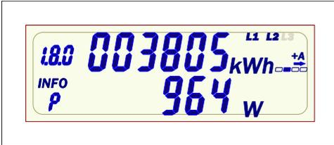
Spannungsausfall einer Phase
